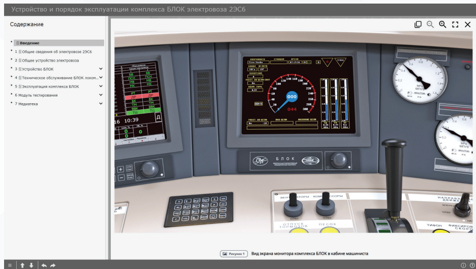
Вид экрана монитора комплекса БЛОК в кабине машиниста
